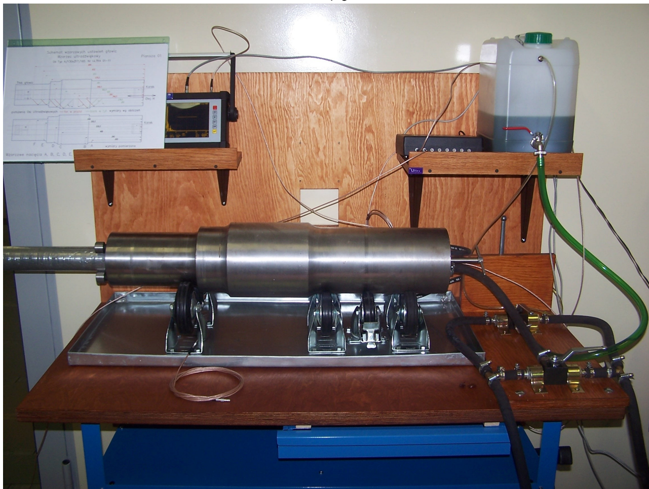
Rys. 6. Stanowisko szkoleniowe do badania kolejowych osi drążonych.
