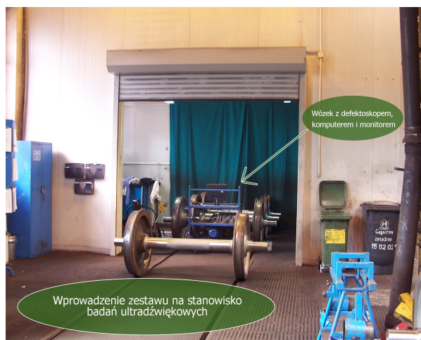
Rys.4 Badanie UT - wydzielone stanowisko ultradźwiękowych badań zestawów kołowych
