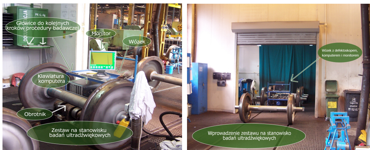
Rys.4 Badanie UT - wydzielone stanowisko badań ultradźwiękowych zestawów kołowych
