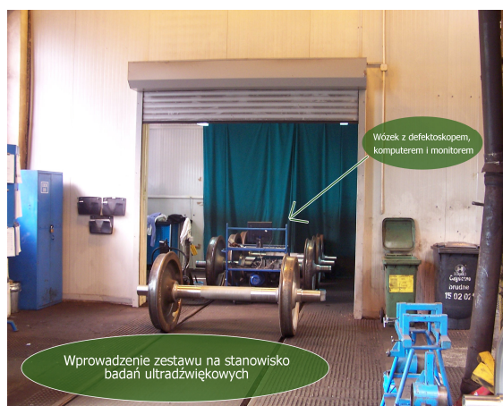
Rys.5 Badanie UT - wydzielone stanowisko ultradźwiękowych badań zestawów kołowych
