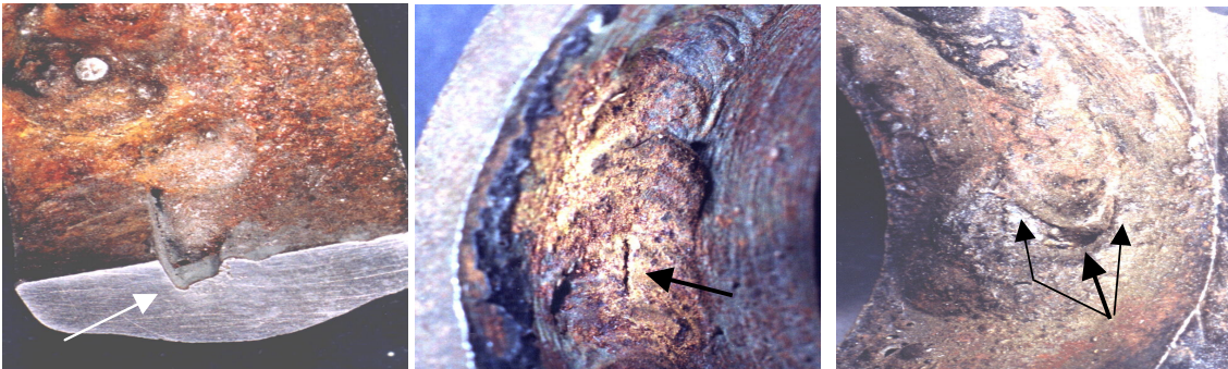
1 Duży brak przetopu w spoinie rury \Phi 38/3 mm
