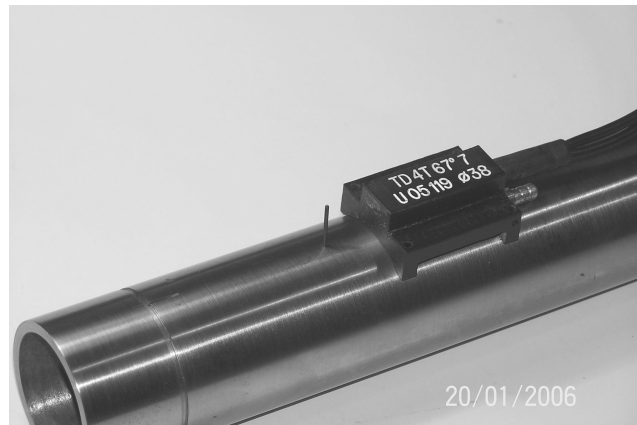
Rys 5 Głowica tandem o oznaczeniach TD 4T67 7, U067 (Ultra Nr.), \varnothing 38, jest to głowica w obudowie PM (Plastyk Mała), o wysokości ok. 10 mm w otworze wzorcowym umieszczono precyk
