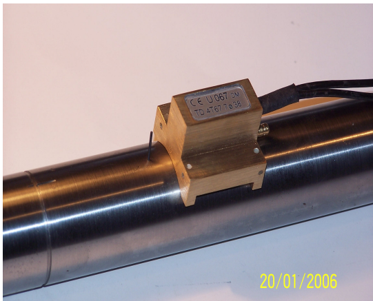
Rys 4 Głowica tandem o oznaczeniach CE, U067 (Ultra Nr.), DM (obudowa Duża Mosiężna), TD 4T67 7, \varnothing 38, o wygodnym uchwycie, w otworze wzorcowym umieszczono precyk
